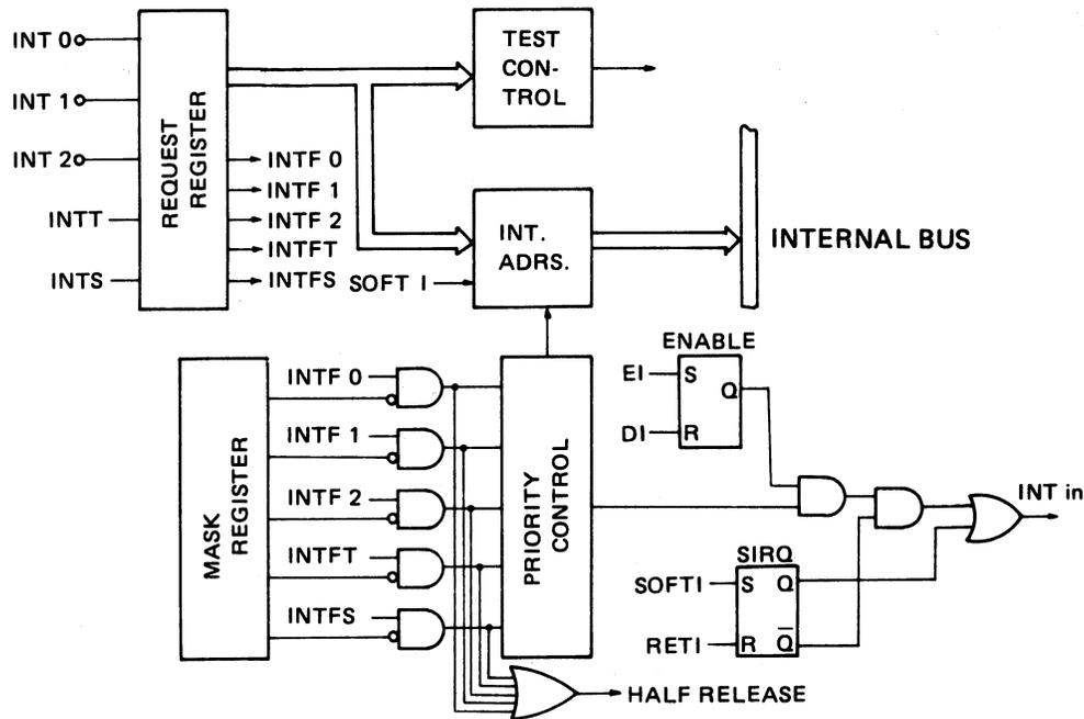
Fig. 5-10 INTERRUPT CONTROL BLOCK
