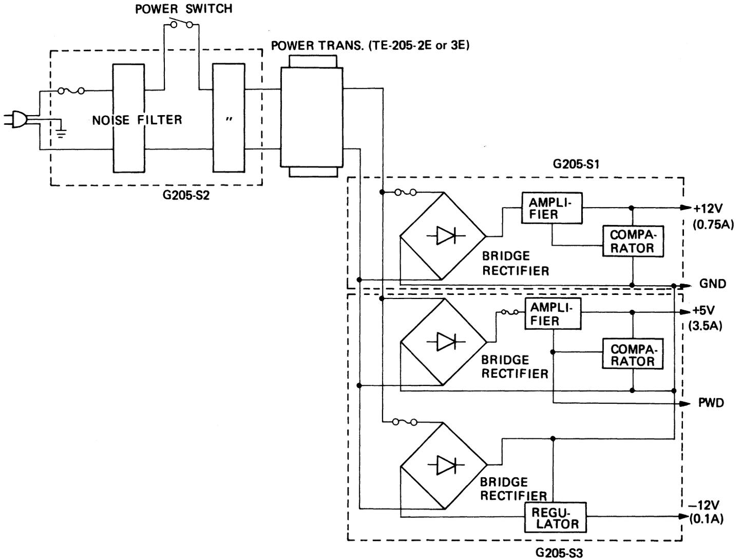
Fig. 8-14 POWER SUPPLY BLOCK DIAGRAM
