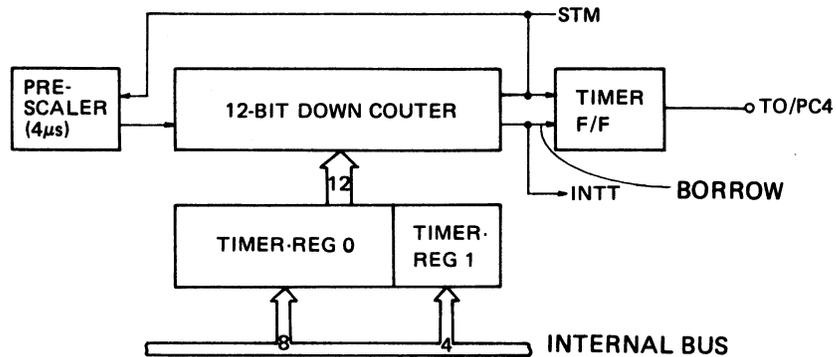
**Fig. 5-9 TIMER BLOCK DIAGRAM**
