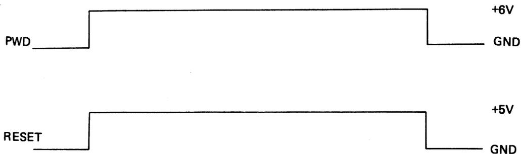
Fig. 8-7 RESET SIGNAL WAVEFORM
