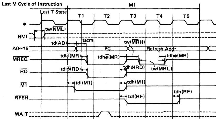
Fig. 5-5 NON-MASKABLE INTERRUPT REQUEST FUNCTION
