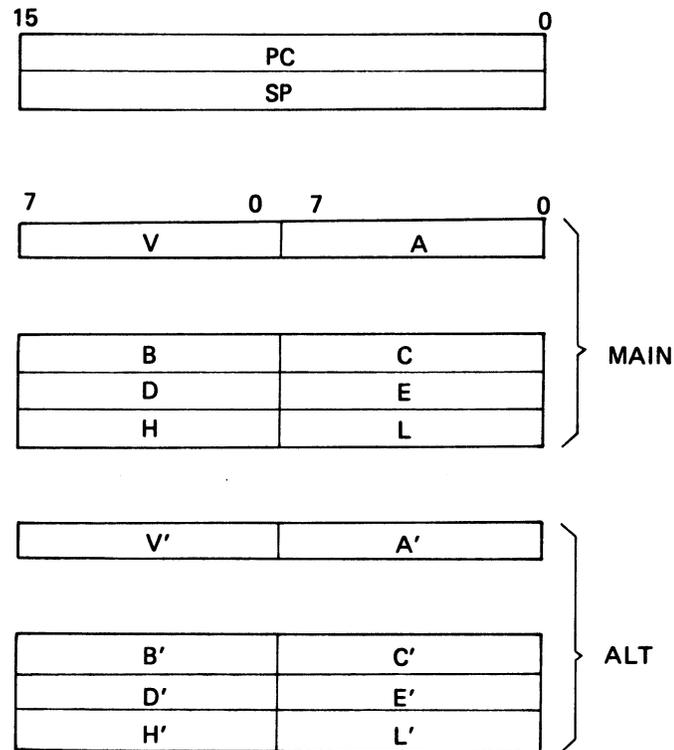
**Fig. 5-7 REGISTER CONFIGURATION**
