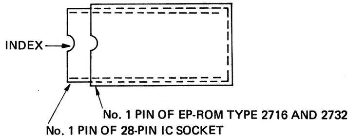
Fig. 4-1 IC SOCKET CONFIGURATION
