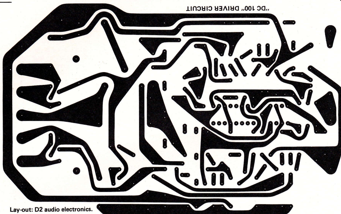
Fig. 11. Print lay-out'et til "DC 100" driver-kredsløbet set fra kobbersiden i størrelsesforholdet 1:1.
