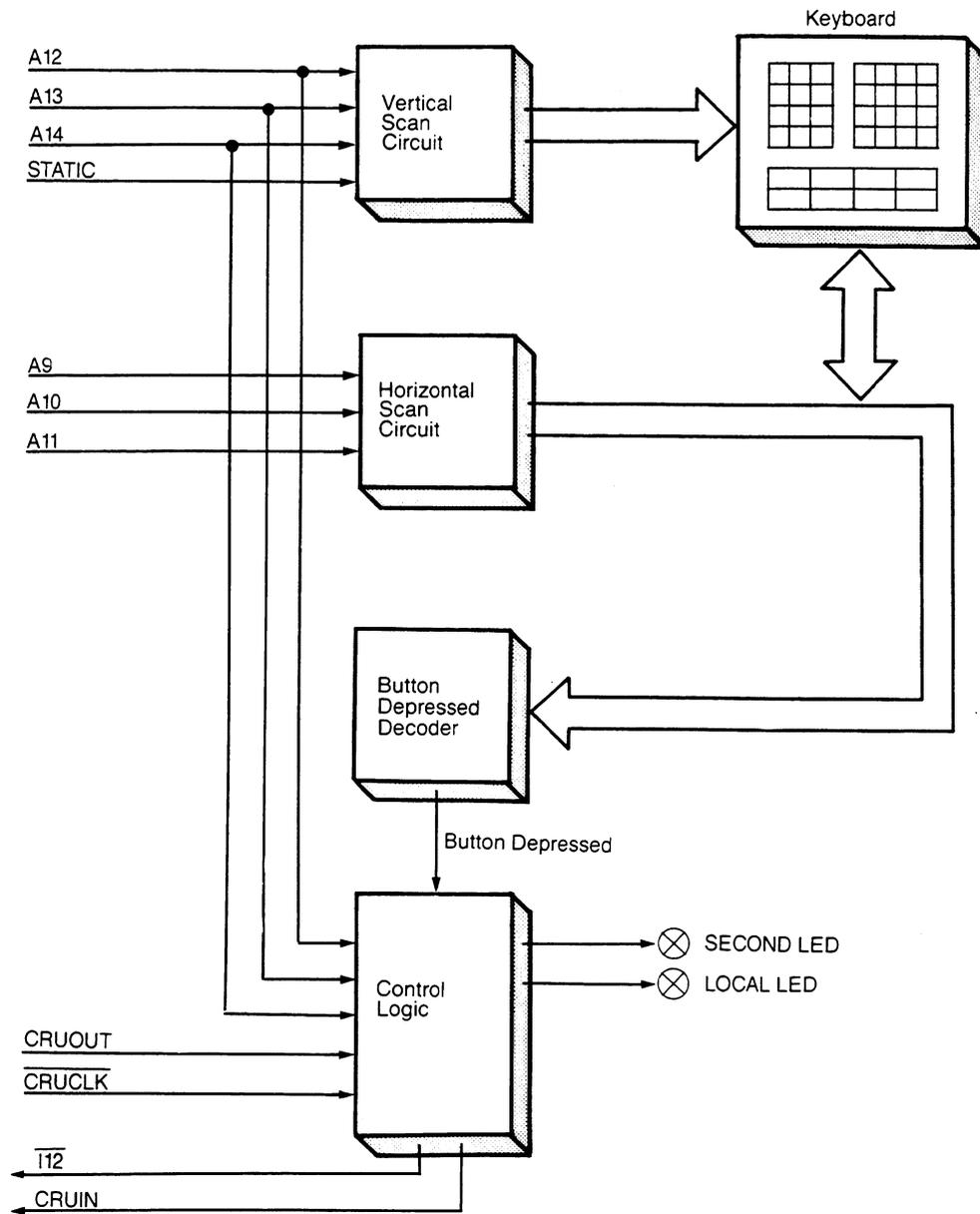
Fig. 3.1 - RE905 Block Diagram
