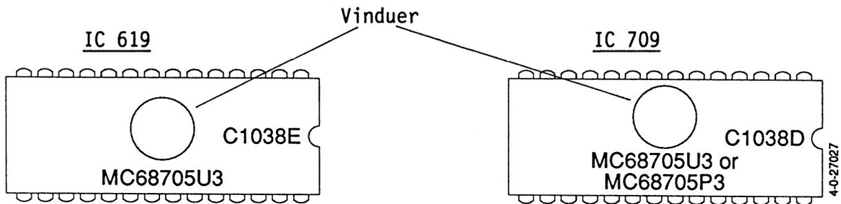
Når man bruger UV-prom processor (MC68705-U3), skal ben 6 (Num) forbindes til  $V_{cc}$  (+5V).
