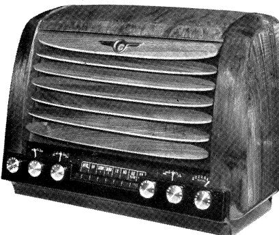
C 8 U er en 8½ rørs supermodtager til universaldrift. Den er forsynet med magisk øje og push-pull udgang, udgangseffekt ca. 8 watt. Til ensretning anvendes en selenventil.
