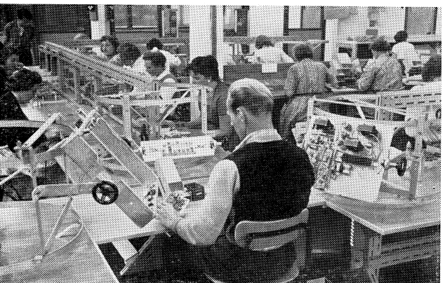
Her er så selve montage-båndets hjerte, hvor de tre chassisdele mødes for derefter at fortsætte og forenes til det færdige apparat.
