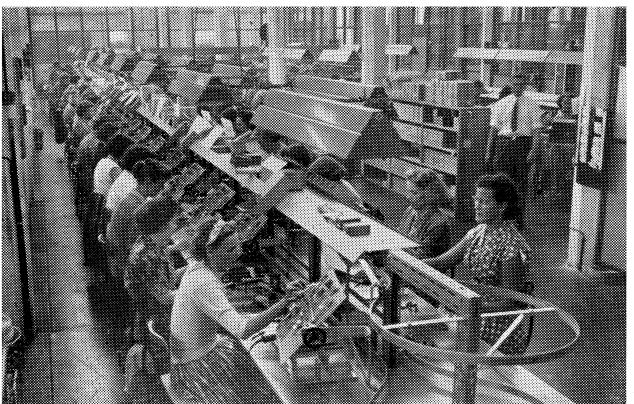
Det nye montagebånd: Chassis'ets tre sektioner kører på tre forskellige skinner og monteres i en bestemt rytme efter et periode-ur.
