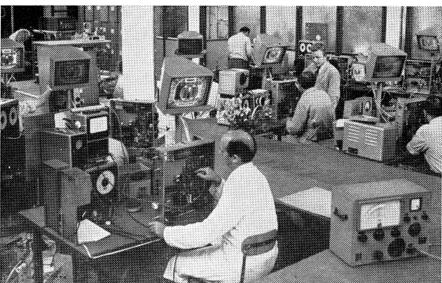
Den nye afprøvnings-afdeling, hvor hver enkelt apparat tilsluttes en moderne monitor, der straks afslører eventuelle fejl i montagen.
