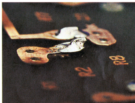
9. Varmeskade på print
